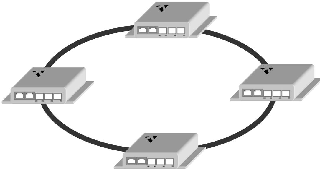
FIGURE 12: REDUNDANT RING CONFIGURATION
